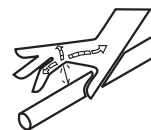
Penetración de líquido hidráulico
