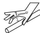
Penetración de líquido hidráulico
