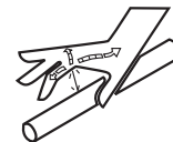
Penetración de líquido hidráulico
