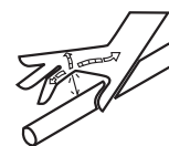
Penetración de líquido hidráulico
