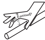
Penetración de fluid hydraulique
