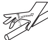
Penetración de fluid hydraulique
