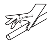
chaude au contact Pénétration D'huile hydraulique
