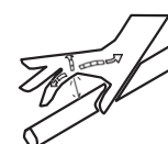
Eindringung von Hydraulik- flüssigkeit
