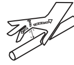
Penetración de fluido hidráulico
