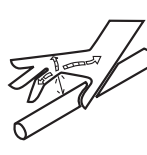
Penetración de líquido hidráulico
