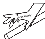
Penetración de fluid hydraulique
